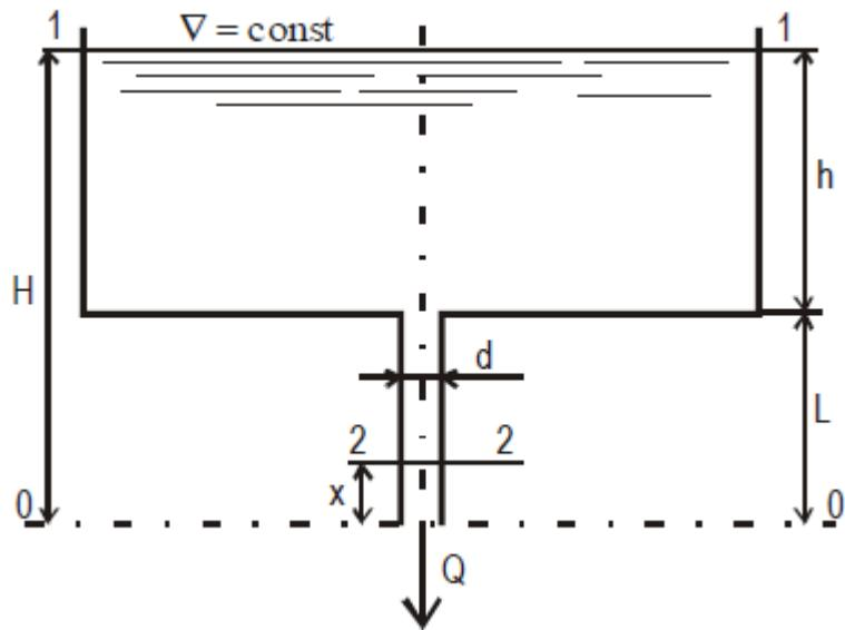
20. Определить напор  $H$ , который необходимо поддерживать в резервуаре, чтобы расход воды, пропускаемый по трубопроводу диаметром  $d$ , равнялся  $Q$ . Угол закрытия крана  $\alpha$ , длина трубы  $L$ . На трубопроводе имеется четыре поворота под углом 90°,  $r/R_3=0,5$ .
