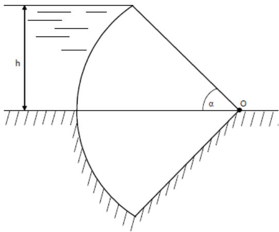
12. В прямоугольном окне вертикальной стенки резервуара установлен на цапфах цилиндрический затвор диаметром  $D$  и длиной  $b$ .
