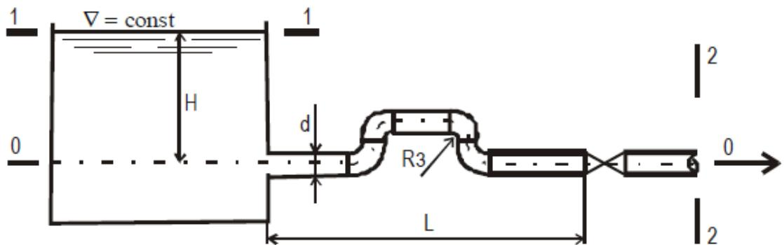
21. На берегу реки предполагается установить насос для подачи воды из реки расходом  $Q$ . Определить расстояние от оси насоса до уровня воды в реке  $h_b$ . Длина всасывающей трубы  $L$ , трубы стальные новые. На всасывающей трубе установлен приемный клапан с сеткой, имеются три поворота трубы под углом 90°, с закруглением  $R_3$ . Допустимая вакуумметрическая высота  $h_{\text{вак}}$ .
