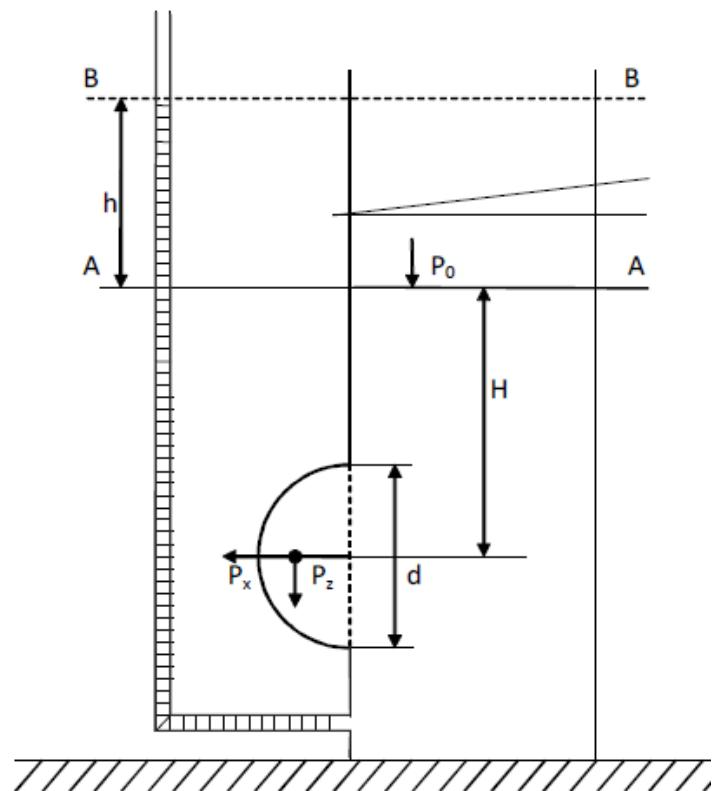
14. Показания манометра, присоединенного к днищу бака, равно  $p_M$ . Найти давление воздуха, находящегося под водой. Определить растягивающее и срезающее усилия болтов, крепящих к вертикальной стенке бака коническую крышку с размером  $d$  и  $l$ ; весом крышки пренебречь.
