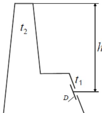
6. Определить силу давления и её точку приложения на затвор, перекрывающей отверстие донного водовыпуска, в двух случаях: затвор прямоугольный; затвор треугольный, вершиной вверх. Ширина затвора  $b$ , глубина погружения его верхней кромки  $l$  и нижней  $h$ . Угол наклона затвора  $a$ . За затвором воды нет.
