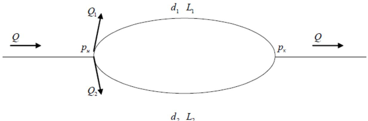
29. Определить потери давления в системе магистрального газопровода, если давление в начале трубопровода  $p_1$ , диаметр трубопровода  $d_1, d_2, d_3$ ; длины  $L_1, L_2, L_3$ ; плотность газа принять при нормальных условиях; расход газа  $Q$ .
