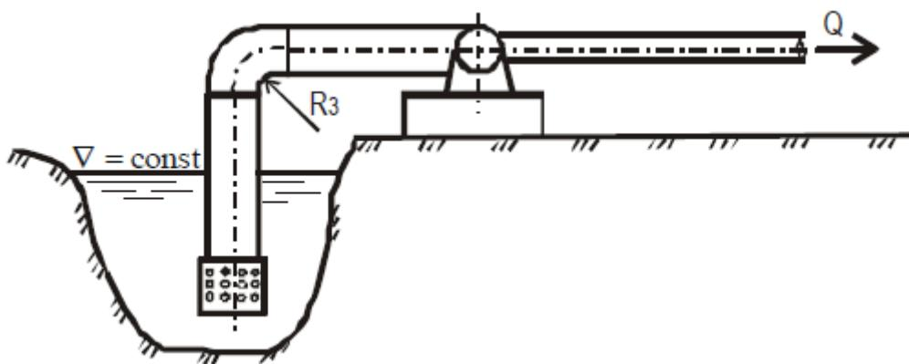
22. Определить разность уровней в баке  $Z$ , которая обеспечивает расход воды  $Q$  по трубопроводу диаметром  $d$ . Степень открытия задвижки на трубопроводе равна  $a/d$ . Длина трубы  $L$ . На трубопроводе имеются четырехповорота с углами 90° со степенью закругления  $r/R_3=0,7$ . Скоростными напорами в баках пренебречь.
