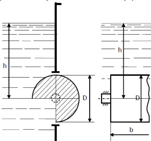
13. Смотровой люк, устроенный в боковой стенке бензозерезервуара, перекрывается полусферической крышкой диаметром  $d$ . Определить усилия открывающеее  $P_x$  идвигающее  $P_z$ , воспринимаемые болтами, если уровень бензина над центром отверстия  $H$ , а манометрическое давление паров бензина равно  $p_0$ . Удельный вес бензина  $\gamma=6867 \text{ Н/м}^3$ .
