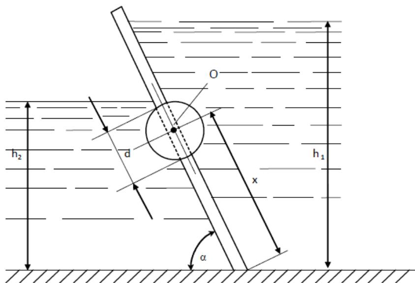
11. Определить силу суммарного давления на секторный затвор и ее точку приложения. Глубина воды перед затвором  $h$ , длина затвора  $L$ , угол затвора  $\alpha$ .
